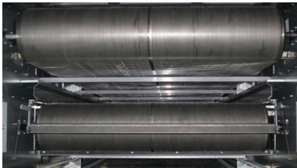
Im Trockner können sowohl unterschiedlichste Arten von Schüttgütern als auch separierte und flüssige (6%TS) Stoffe getrocknet werden.
